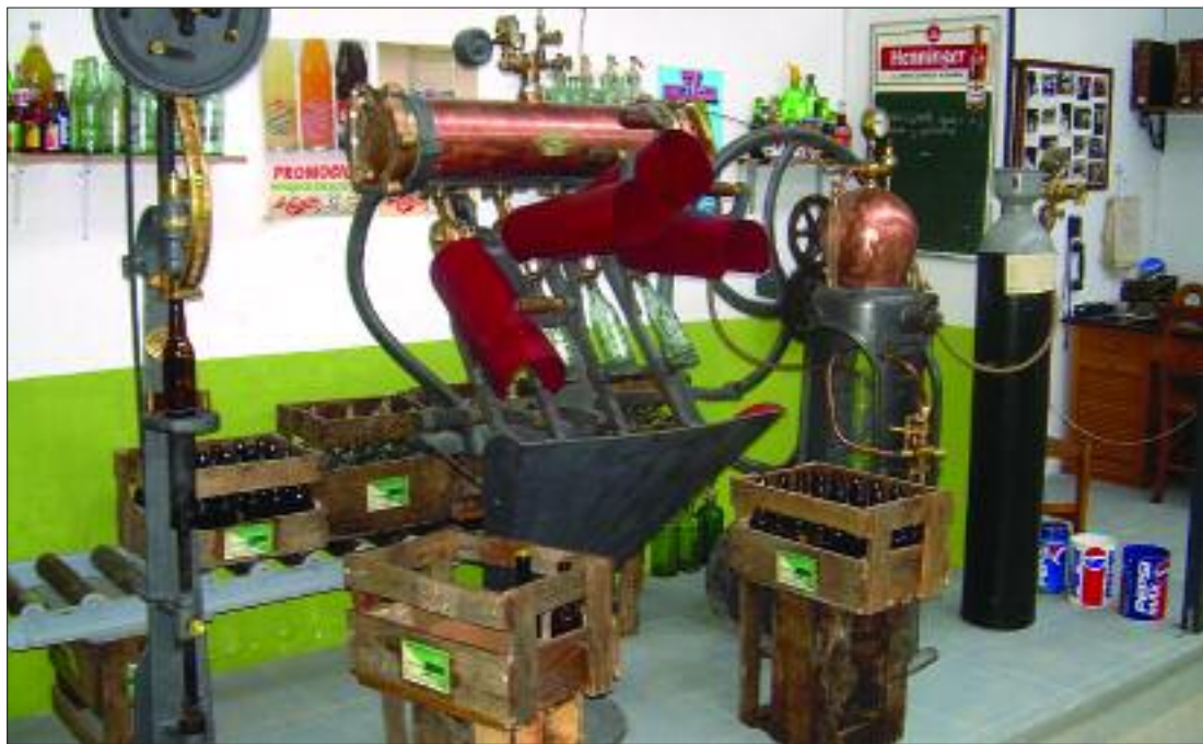
► De drcha a izqrd, botella de anhídrido carbónico. saturadora llenadora y taponadora de gaseosas
